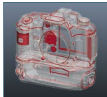
Ein lückenloses System: Die K10D ist mit 72, und der Batteriegriff mit 38 Dichtungen, an allen relevanten Stellen vor Feuchtigkeit und Staub oder Sand geschützt. Hiermit bietet PENTAX den zurzeit besten Schutz.
